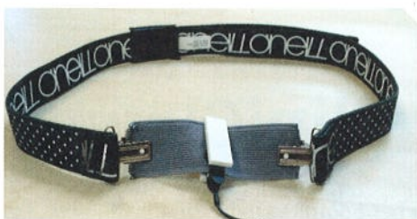
Afbeelding 2: De band om de borst bestaat uit een combinatie van een matig-rekkende band (zwart) en een goed rekkende band (grijs). De optische opnemer is in een afschuifbare houder gezet (wit).
